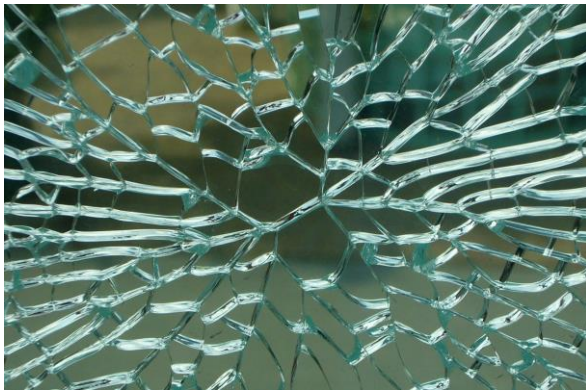
Illustration 3: image de casse VST avec structure en forme de papillon
