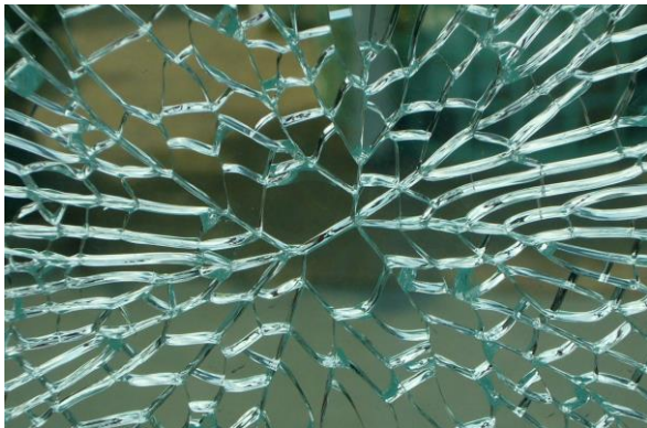
Abbildung 3: Bruchbild ESG mit Schmetterlingsstruktur
