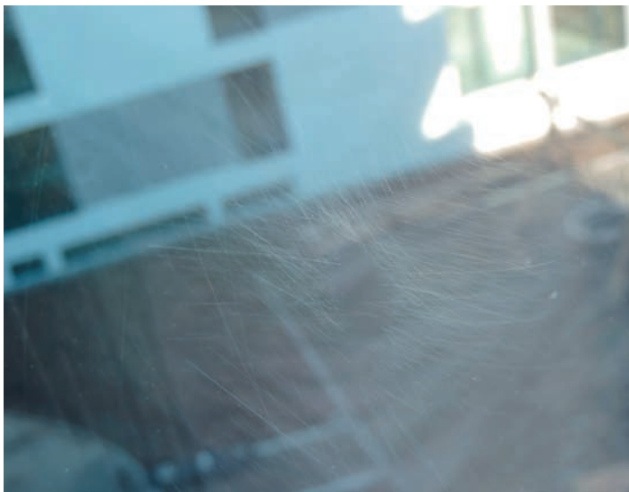
Kratzerschar mit klarer Stelle nach dem Entfernen von Rückständen und Schmutz.
