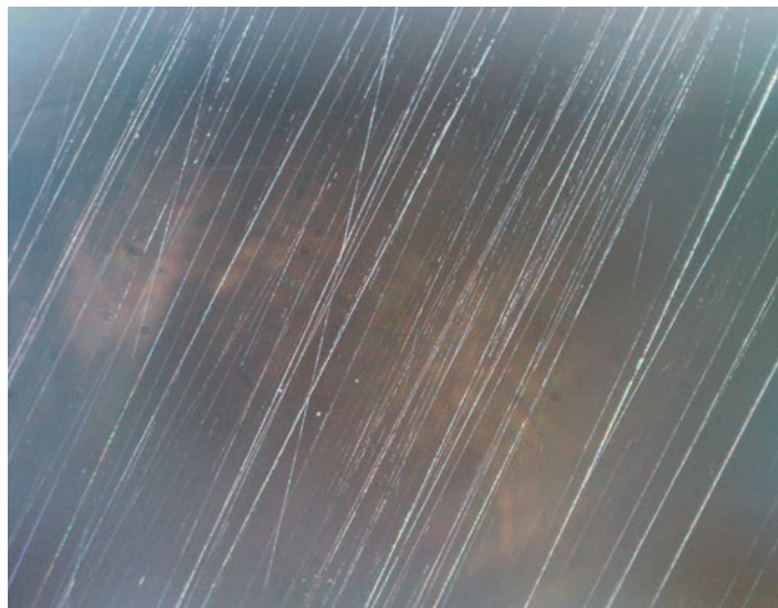
Gehäuft vorkommende horizontale Haarkratzer nach einer Endreinigung unter dem Mikroskop.
