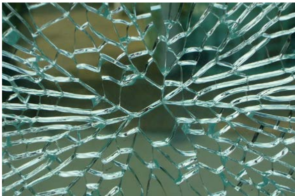
Abbildung 3: Bruchbild ESG mit Schmetterlingsstruktur
